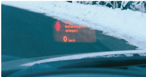
Die Fahrbahn überblicken und gleichzeitig über die Fahrzeuggeschwindigkeit informiert sein: das Head-up-Display macht's möglich.
