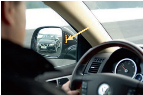
Der Totwinkelassistent hilft dem Fahrer, beim Spurwechsel den Überblick zu behalten.
