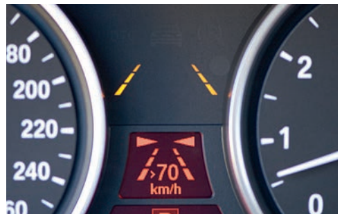
Das Display im Armaturenbrett zeigt an, dass der Spurassistent aktiv ist.
